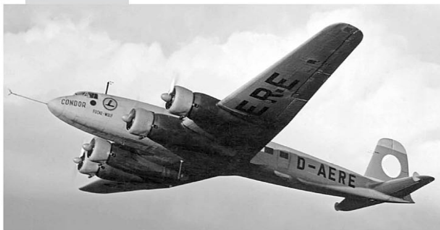
Als D-AERE geht die Fw 200 V1 in die Flugerprobung. Gut zu erkennen ist die ursprüngliche Ausführung der Tragflächen mit fast gerader Vorderkante. The Fw 200 V1 commenced its flight tests registered as D-AERE. Clearly visible is the original version of the wing with almost straight forward leading edge. (Ott Collection)
