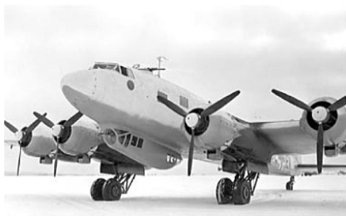
Das Führerflugzeug CE+IB und alle später noch von der F.d.F. als Reiseflugzeuge übernommenen Fw 200 sind gut an der verkürzten Bodenwanne zu erkennen. The aircraft of the Führer, CE+IB and all subsequent Fw 200 taken over by the F.d.F. are easily recognizable by the shortened ventral tub. (Ott Collection)
